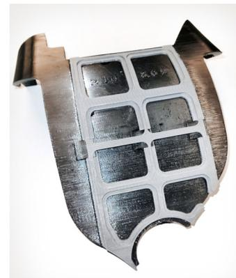
Dispositivo di posizionamento dell'emblema stampato in 3D con telaio in fibra di carbonio (grigio) e supporto in TPU.
