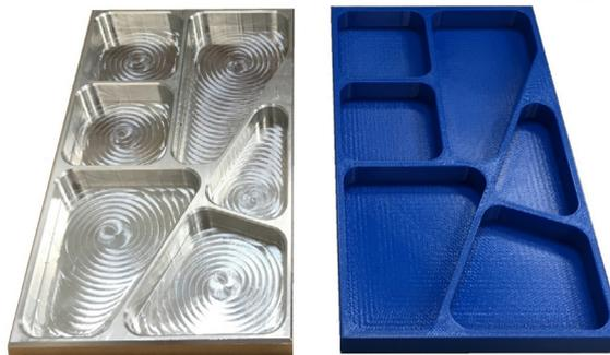
Image 1: CNC (aluminium) à gauche, en 3D (plastique) à droite.
