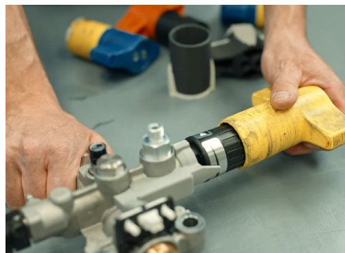
A ferramenta manual anterior do ABS (amarela) é mostrada, acoplando o botão de ajuste em um dispositivo de controle de pressão.
