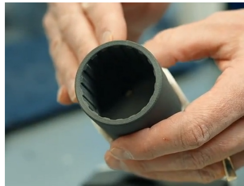
O soquete de ferramenta manual impresso em 3D, mostrando as estrias e o acabamento liso da superfície impressa.
