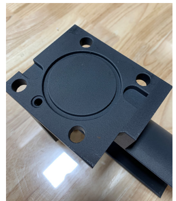
Der Montageflansch der Auffangvorrichtung weist das mit dem FDM-Material Nylon-CF10 erreichbare Oberflächenfinish auf.
