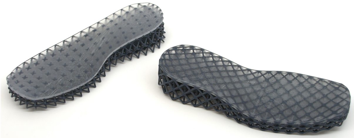
Die DManD-Forscher druckten für diesen Schuhprototyp Multimaterial-Weichgitterstrukturen unter Verwendung eigener Design-, Analyse- und Slicer-Tools zur räumlichen Kontrolle der Steifigkeit und der nichtlinearen Verformung.
