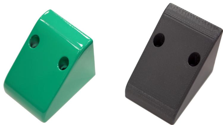
Boîtiers de protection imprimés en 3D résistants, mais légers, utilisés sur les machines d'emballage robotisées. Ils ont été fabriqués sur une Fortus 450mc de Stratasys avec le matériau FDM Nylon 12CF, et un vernis de finition de couleur verte.
