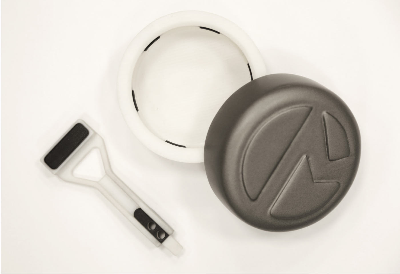
Eine Greifzange (links) und ein Verpackungsdeckel (rechts) – 3D-gedruckt mit der Stratasys PolyJet-Technologie. Multimaterial-3D-Druck für die Fertigung weißer Strukturkomponenten und schwarzer gummiartiger Griffe in einem einzigen Druckvorgang
