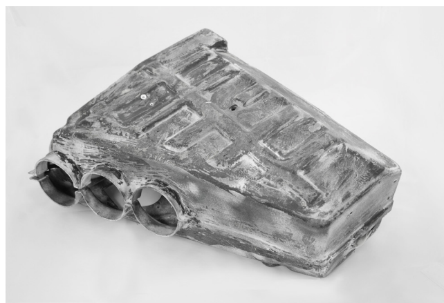
Condotto dell'aria condizionata obsoleto da sostituire su una supercar storica
