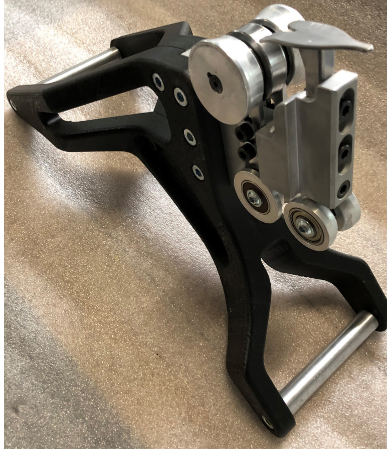
RUSTIN a employé le matériau FDM Nylon12CF de Stratasys pour créer ce dispositif permettant le montage des joints de pare-brise des tramways de la compagnie de transport de Francfort.
