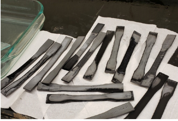
Figure 4. Échantillons après exposition au DCM.
