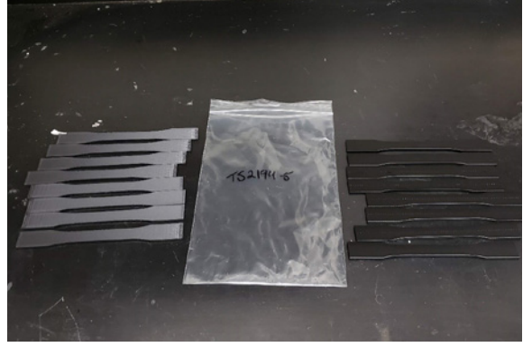
Figure 5. Échantillons après exposition à l'acétate d'éthyle.
