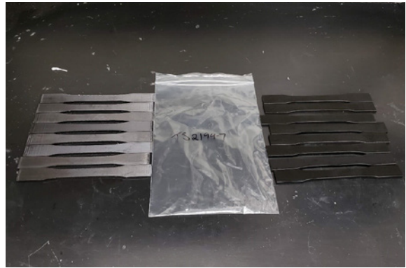
Figure 7. Échantillons après exposition au Jet A.
