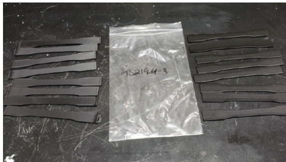
Figure 3. Échantillons après exposition au MEK.
