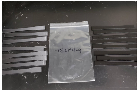
Figure 9. Échantillons après exposition à 30 % d'acide sulfurique.
