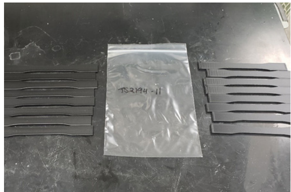
Figure 11. Échantillons après exposition à du concentré d'ammoniaque.
