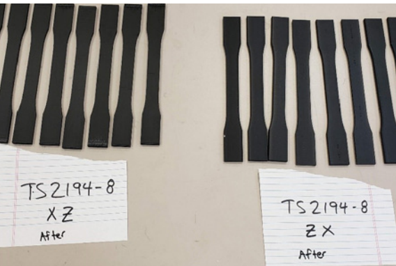
Figure 8. Échantillons après exposition à 30 % d'acide nitrique.
