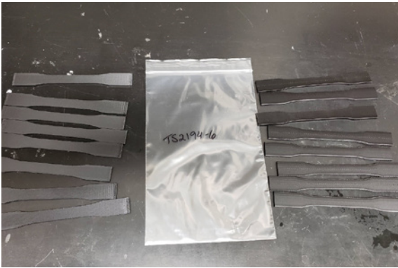
Figure 6. Échantillons après exposition au toluène.
