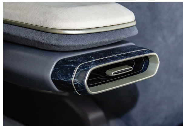
3D-gedruckter Diffusor der Klimaanlage mit Marmoreffekt - hergestellt mit der Stratasys J750.
