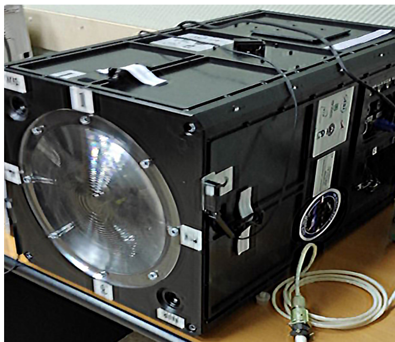
La structure du Mini-EUSO Flight Model a été imprimée en 3D avec de la résine ULTEM™ 9085 sur une imprimante 3D Fortus 450mc.
