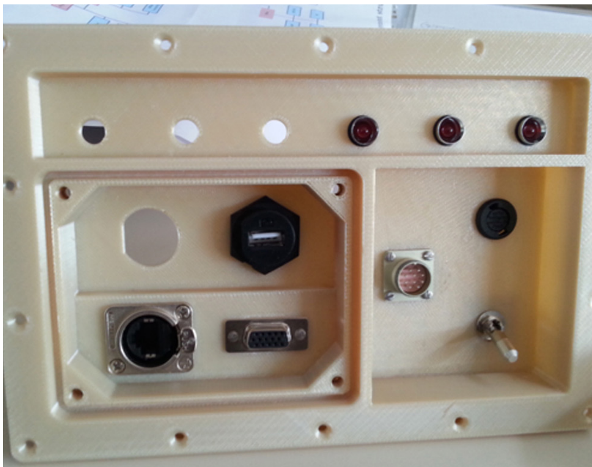
Une pièce du Mini-EUSO produites en résine ULTEM™ 9085 par l'équipe du Laboratori Nazionali di Frascati avec son imprimante 3D Stratasys Fortus 450mc.
