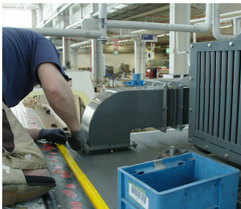
Versione finale del sistema di ventilazione personalizzato stampato in 3D con la resina ULTEM™ 9085.
