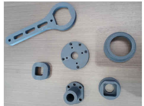
Pièces d'un outil d'extraction de boulons en matériau Nylon-CF10.
