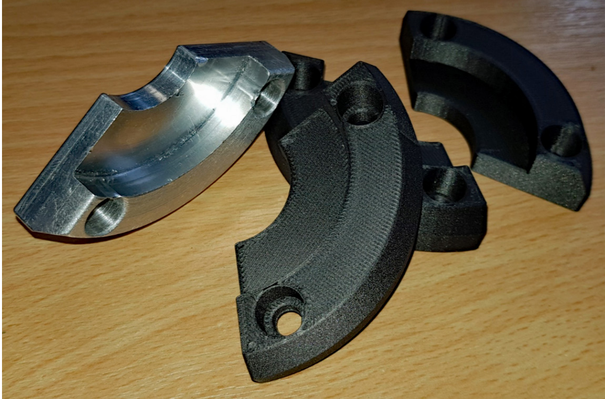
Un accessorio per la ganascia stampato in 3D con il Nylon 12CF FDM, che permette di risparmiare fino all'80% del tempo di allestimento del macchinario.
