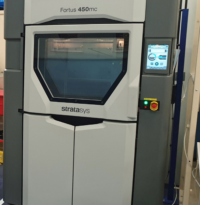
La stampante 3D Fortus 450mc installata nella sede della John Crane a Slough.
