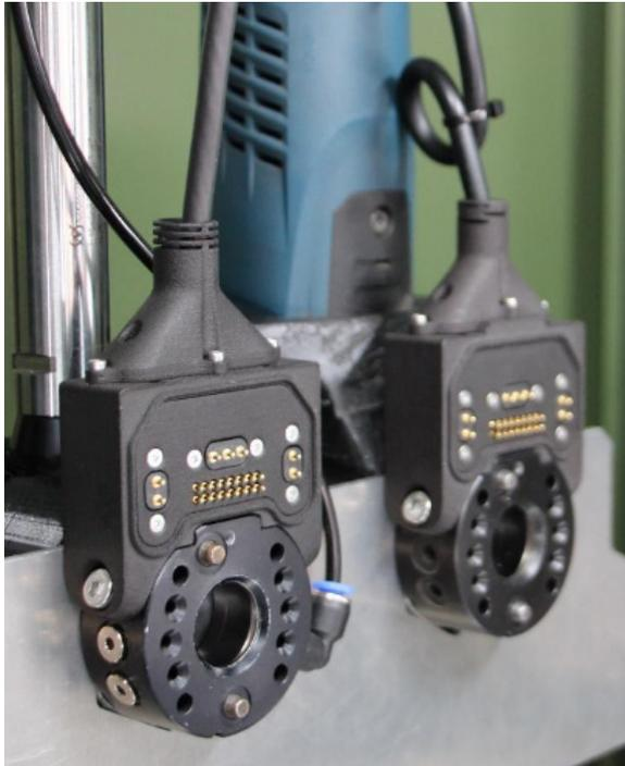
É vital que o conector possa ser utilizado em várias ferramentas e suportar altas correntes. Cada pino de energia de alta corrente pode suportar até dez amperes. Os pinos de dados de corrente mais baixa são capazes de transmitir de forma confiável uma corrente de até um ampere cada um.
