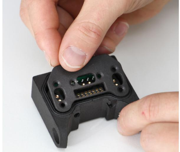
Embora tanto o PA11 de alto rendimento quanto o PA12 sejam adequados para conectores, a SAF™ PA12 foi utilizada nesta instância específica, pois apresenta rigidez e precisão aprimoradas. Em comparação, o PA11 possui excelente resistência ao impacto e ductilidade para aplicações que experimentam cargas mais dinâmicas.
