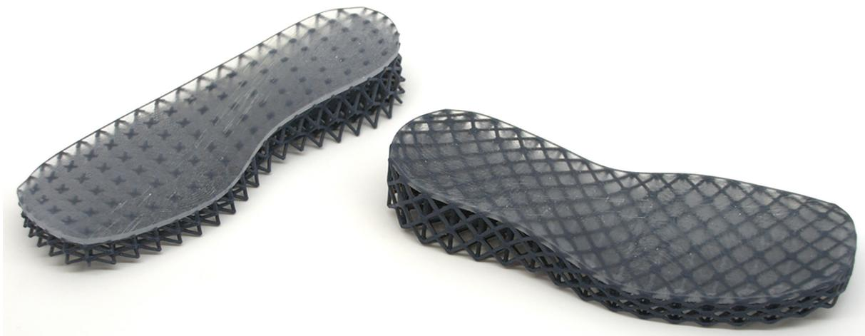
Les chercheurs du DManD ont créé des structures multi-matériaux en treillis souple pour ce prototype de chaussure au moyen d'outils de conception, d'analyse et de découpage personnalisés pour contrôler spatialement la rigidité et la non-linéarité.
