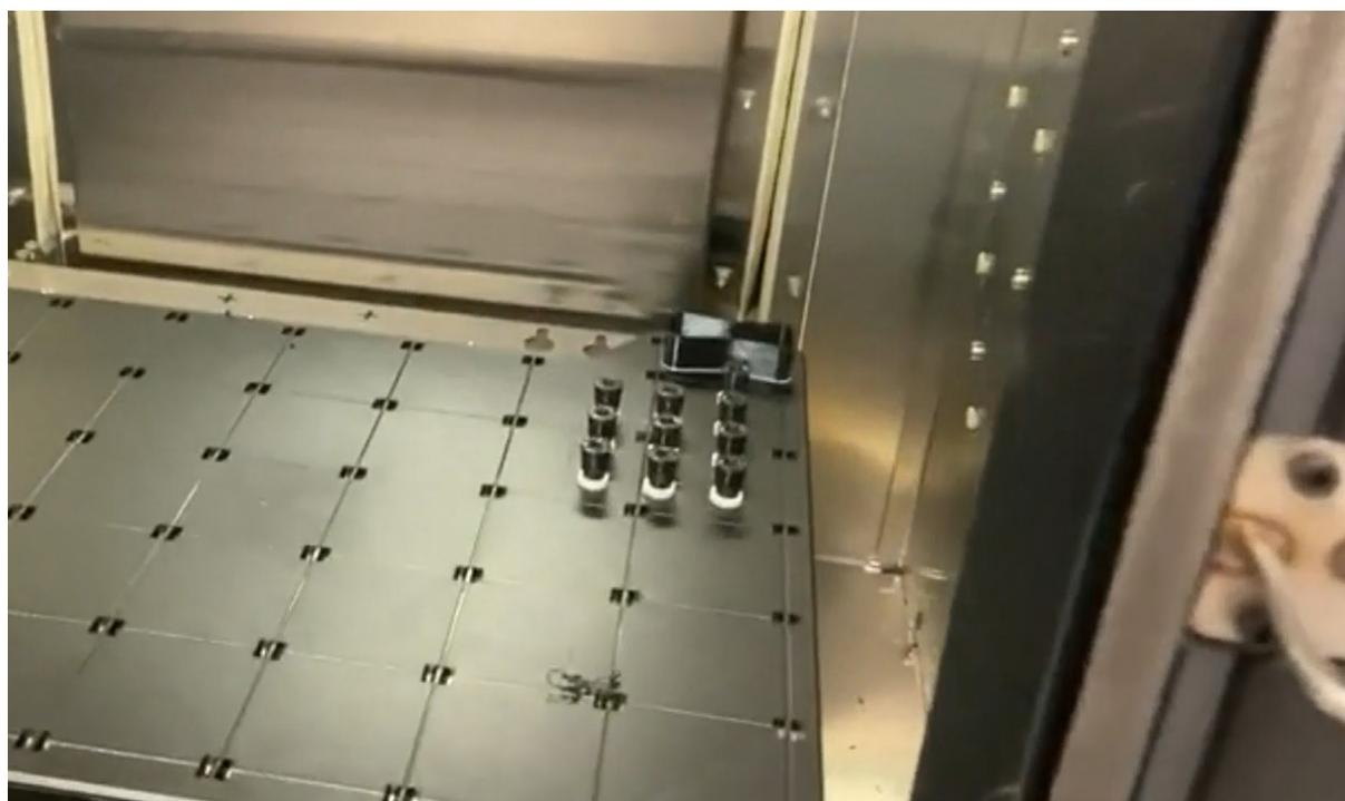
Grâce à l'impression 3D FDM de Stratasys, Alstom a pu concevoir, fabriquer et livrer une douzaine de bouchons haute résistance en seulement 48 heures après avoir reçu la demande de Sétif.
